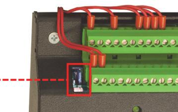
Das Zündsteuergerät übermittelt über den Hilfssynchronisationsausgang (ASO) das Zündsignal des ersten Zylinders in Zündreihenfolge an das DetConz/20. Alle weiteren Zündzeitpunkte werden vom DetConz/20 errechnet.
