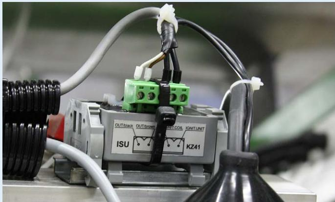
Beachten Sie weiterhin, dass die Kontakte des Steckers offen liegen und vor Feuchtigkeit und Verschmutzung geschützt werden müssen. Bei einem entsprechenden Standort des Motors kann der Zündimpulssensor beispielsweise in einer Verteilerdose montiert oder im Schaltschrank untergebracht werden.
