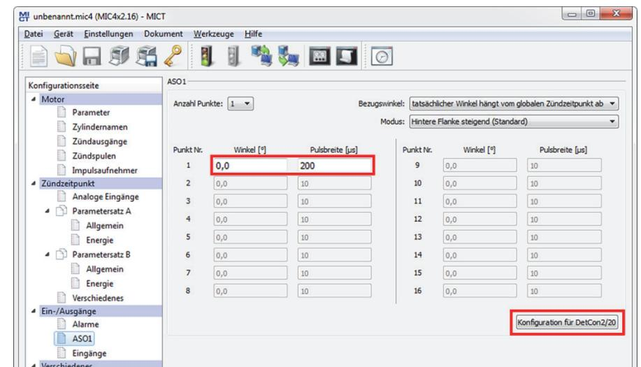
Über das analoge Stromsignal (4-20 mA) übermittelt das DetConz/20 die erforderliche Zündzeitpunktverstellung an das Zündsteuergerät.
