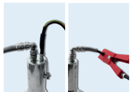
Zur Verwendung mit MOTORTECH-Zündspulen mit Diagnoseschnittstelle oder geschirmter Primärleitung.
