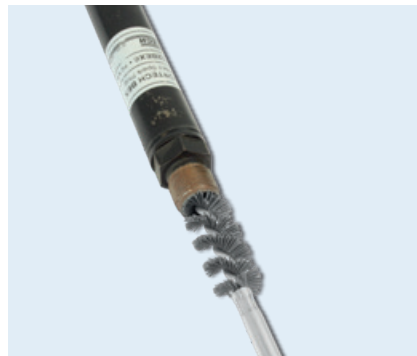
Reinigung von Zündkerzen mit verlängertem Gehäuse
