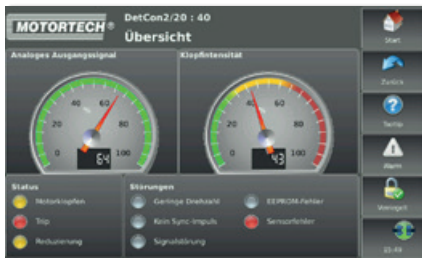
Übersicht Anzeige der wichtigsten Betriebsdaten des angeschlossenen DetCon-Steuergerätes
