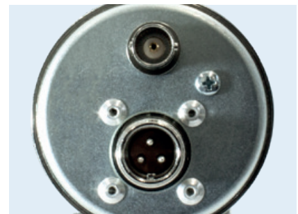
Zusätzlicher BNC-Anschluss für Hochspannungsmessung
