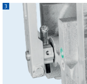
Endanschlag mit Einstellschraube für Leerlaufdrehzahl
