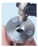
3 Der integrierte Schnellverschluss garantiert einen schnellen Wechsel sowie sicheren Halt der Zündkerzen während der Einstellung.
