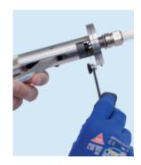
4 Ein sanfter Druck des Hebels ist ausreichend, um den Elektrodenabstand mit Hilfe einer Fühlerlehre auf das gewünschte Maß einzustellen.
