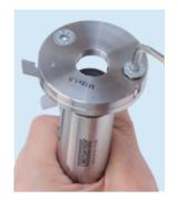
2 Für die Aufnahme der einzustellenden Zündkerze stehen Gewindeadapter in unterschiedlichen Größen zur Verfügung (M14, M18 oder 7/8 Zoll). Die Adapter lassen sich mit den enthaltenen Schrauben und dem Inbusschlüssel leicht montieren oder austauschen.
